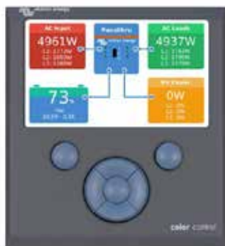
Color Control GX, montrant une application PV
