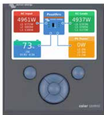
Color Control GX, montrant une application PV
