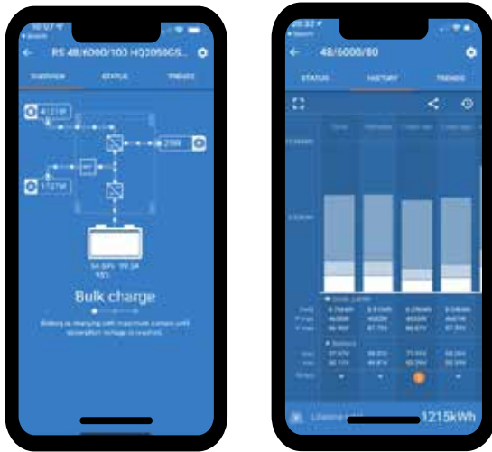
Configuration et surveillance avec VictronConnect Une connexion Bluetooth Smart intégrée permet une surveillance et un réglage rapides des paramètres sur le Multi RS.
